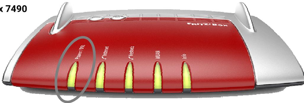
Wenn die Power-LED durchgängig leuchtet, können Sie den USB-Stick aus dem USB-Anschluss auf der Rückseite der FRITZ!Box herausnehmen oder ihn weiterhin stecken lassen. Bewahren Sie den USB-Stick aber unbedingt auf, er wird bei einer eventuellen Neuinstallation wieder benötigt.
